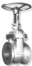
GAVETA CASTELO APARAFUSADO API 600, Classes de pressão ASME 150-1500, 2-60" (50-1500 mm)
