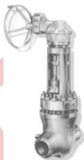
CASTELO APARAFUSADO Classes de pressão ASME 150-1500, 2 - 24" (65-600 mm) Cunha Flexível ou paralela
